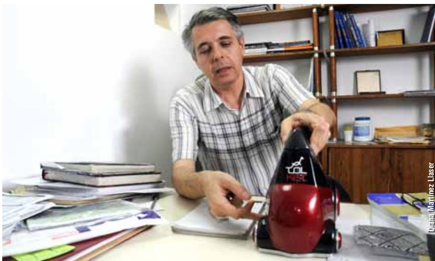
Tolket acaba de presentar el ELAL Mobile, una nueva versión del equipo de acreditación de limpieza, absolutamente portátil, que permite su desplazamiento a cualquier punto de la planta. “El nuevo modelo resulta ideal para ofrecer servicios de medición a cualquier empresa que no quiera o no pueda pagar el costo de comprar un equipo”, se entusiasma Martínez.
