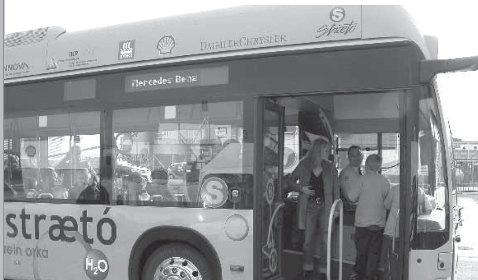
Uno de los tres ómnibus Daimler-Chrysler, impulsado por un motor alimentado con hidrógeno gaseoso, que circula de manera experimental por las calles de Reykiavik, capital de Islandia.
